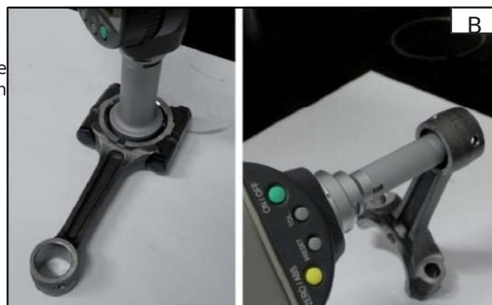
Antes de montar los cojinetes de bronce (8) de la cabeza de biela, médalos con un micrómetro específico, ver Fig. C.
