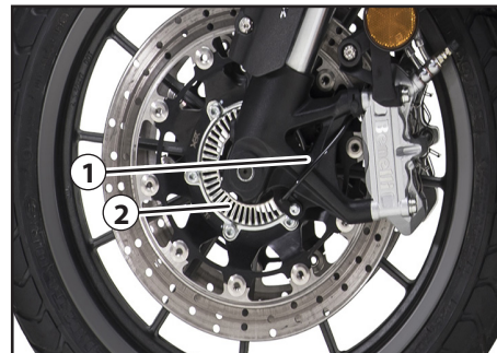
1. Sensor de la rueda delantera 2. Rotor del sensor de la rueda delantera
